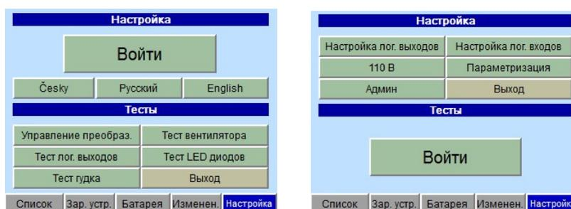
В меню Настройка логических выходов за каждым из десяти выходов можно закрепить конкретную функцию. За одним выходом можно закрепить несколько функций или отменить их. Здесь также отображается текущее состояние данного выхода.
